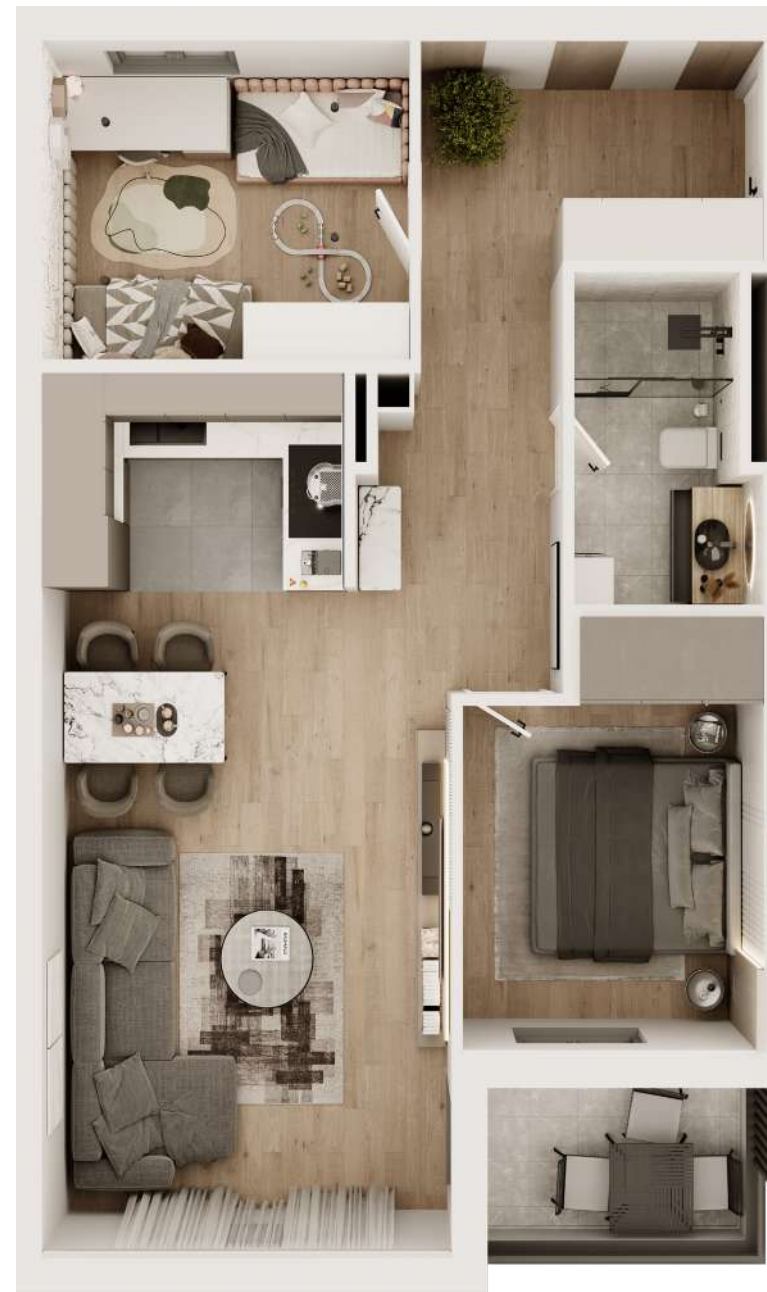
1. ulaz 4,85 m 2 2. hodnik 4,64 m 2 3. kuhinja 4,95 m 2 4. blagovaonica i dnevni boravak 20,75 m 2 5. spavaća soba 1 9,75 m 2 6. spavaća soba 2 9,20 m 2 7. kupaonica 4,85 m 2 8. natkriveni balkon 4,42 x 0,50 = 2,21 m 2
